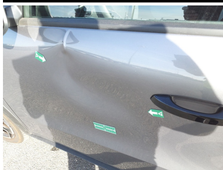
Porte / Avant Gauche / Enfoncement
